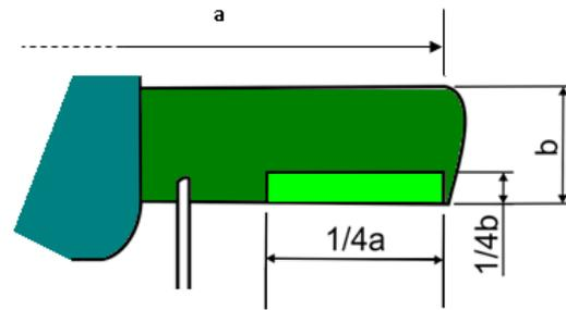
Fig. 4 Ratio values of ailerons
